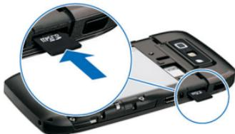
2. Setzen Sie die Speicherkarte in den Steckplatz ein. Achten Sie dabei darauf, dass Sie die Seite mit den Kontakten zuerst in den Schlitz schieben. Achten Sie darauf, dass der Bereich mit den goldfarbenen Kontakten in Richtung der Kontakte des Geräts zeigt.
