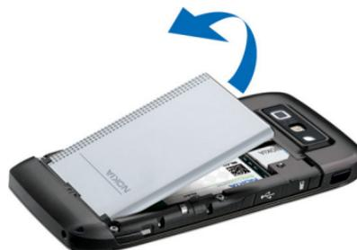
3. Setzen Sie die SIM-Karte ein. Achten Sie darauf, dass der Kontaktbereich der Karte in Richtung der Kontakte des Geräts und die abgeschrägte Ecke zur Geräteoberseite zeigt.
