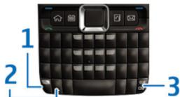
**1** — Funktionstaste. Um die Ziffern und Zeichen einzufügen, die oben auf den Tasten abgebildet sind, halten Sie die Funktionstaste gedrückt und drücken dann auf die entsprechende Taste. Alternativ können Sie auch entsprechende Taste gedrückt halten. Um nur die Zeichen einzugeben, die oben auf den Tasten abgebildet sind, drücken Sie zweimal kurz auf die Funktionstaste.
