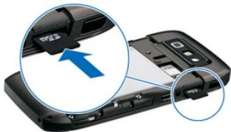
2. Inserte la tarjeta de memoria en la ranura (la zona de contacto primero). Asegúrese de que la zona de contacto esté orientada a los conectores del dispositivo.
