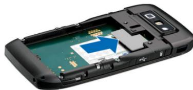
4. Inserte la batería. Alinee los contactos de la batería con los conectores correspondientes del compartimento de la batería e insértela en la dirección de la flecha.
