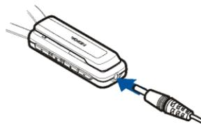
Der vollständig geladene Akku ist ausreichend für bis zu 8 Stunden Sprechzeit oder bis zu 200 Stunden Bereitschaftszeit. Die Sprech- und Bereitschaftszeiten hängen jedoch von dem verwendeten Telefon ab. Zudem werden diese Zeiten von den Geräten beeinflusst, die über Bluetooth Funkverbindungen angeschlossen sind und werden von den Einstellungen, den Bedingungen und der Umgebung für die Verwendung des Geräts bestimmt.
