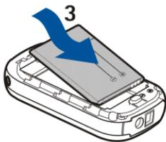
3. Chiudere il cover posteriore (4) e farlo scivolare nella direzione della freccia (5) fino a quando non si blocca.
