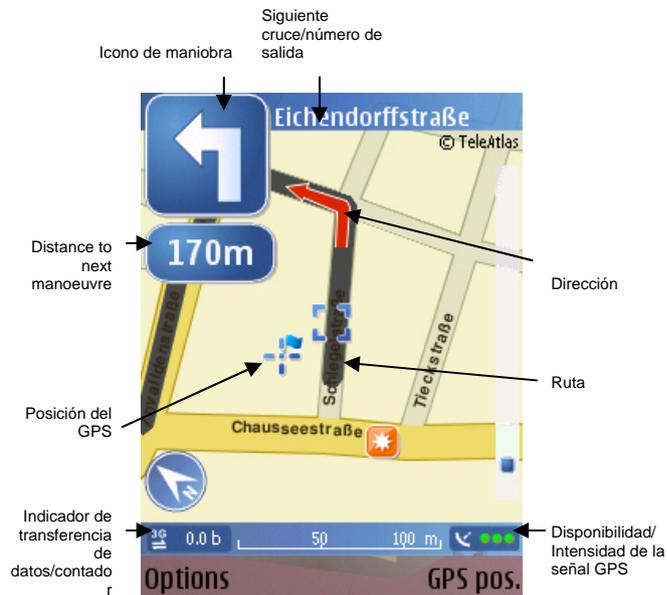
En el mapa de la navegación con instrucciones, la ruta se muestra en gris. La flecha roja muestra la dirección. La flecha azul muestra la posición GPS. Los giros se muestran en la esquina superior izquierda y se indican mediante guía de voz.
