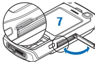
2 Inserire una memory card compatibile nello slot (8), mantenendo l'area di contatto sulla carta rivolta verso l'alto e l'angolo smussato rivolto verso la base del dispositivo.
