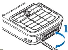
2. Setzen Sie die Speicherkarte in den Steckplatz ein (2). Stellen Sie sicher, dass der Kontaktbereich auf der Speicherkarte nach oben in Richtung Steckplatz weist.
