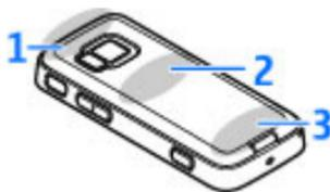
1 — Antena Bluetooth e LAN sem fios, e receptor GPS
