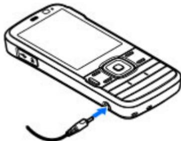
2. Conecte el cable de alimentación al dispositivo.
