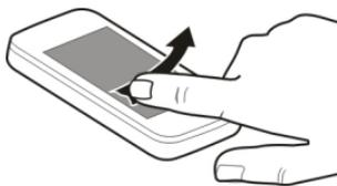
Coloque un dedo en la pantalla y deslícelo firmemente en la dirección deseada.
