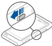
**Sugerencia:** Si el interruptor de bloqueo está fuera de alcance, para desbloquear el dispositivo, pulse la tecla de menú y seleccione **Desbloq.**.
