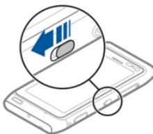
**Conseil :** Si le commutateur de verrouillage est hors de votre portée, déverrouillez l'appareil en appuyant sur la touche de menu et en sélectionnant **Déverrouill.**
