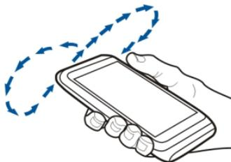
La précision de la boussole est limitée. Les champs électromagnétiques, les objets en métal ou d'autres facteurs externes peuvent également affecter la précision de la boussole. La boussole doit toujours être correctement étalonnée.
