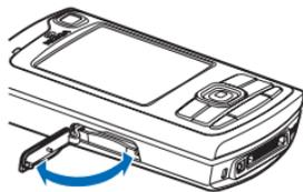
2 Inserte la tarjeta de memoria en la ranura. Compruebe que el área de contacto de la tarjeta queda orientada hacia arriba y hacia la ranura, con el ángulo biselado orientado hacia la base del dispositivo.
