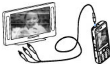
Mientras el cable de conectividad de vídeo de Nokia está conectado al dispositivo, todos los sonidos, incluidas las llamadas activas, sonidos estéreo del videoclip, señales de llamada y tonos de las teclas, se desvían al televisor. El micrófono del dispositivo se puede utilizar con normalidad.
