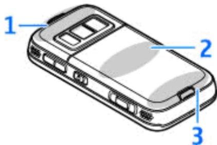
1 — Antena Bluetooth y LAN inalámbrica, y receptor GPS
