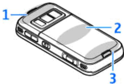
1 — Technologie Bluetooth, antenne LAN sans fil et récepteur GPS
