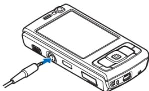
Non collegare prodotti che creano un segnale di output, in quanto ciò potrebbe danneggiare il dispositivo. Non collegare alcuna fonte di tensione al connettore AV Nokia.
