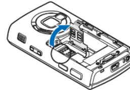
3 إدراج بطاقة SIM أو بطاقة USIM. تأكد من أن منطقة الالتماس في البطاقة تواجه الموصلات في الجهاز، وأن الركن المشطوف في البطاقة يواجه قاعدة الجهاز.
