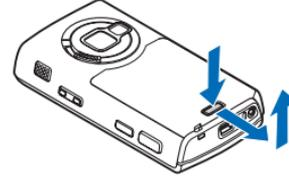
2 لتحرير حامل بطاقة SIM أو بطاقة USIM، ارفع الحامل لأعلى من المقبض.
