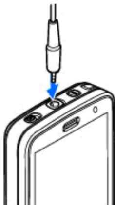
Vous pouvez aussi raccorder un câble de sortie TV compatible au connecteur AV Nokia (3,5 mm) de votre appareil. [Voir "Mode sortie TV", p. 54.](#)
