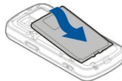
5. Para volver a colocar la tapa trasera, dirija las pestañas de cierre hacia sus ranuras y presione hasta que la tapa quede colocada en su sitio.
