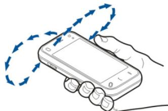
Gire el dispositivo alrededor de todos los ejes en un movimiento continuo hasta que el indicador de calibración cambie su color a verde 🟢. Si el indicador es amarillo 🟡, la precisión de la brújula es baja. Si el indicador es rojo 🔴, la brújula no está calibrada.
