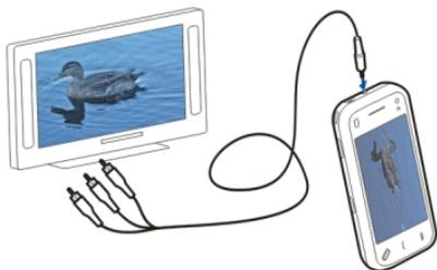
Tutto l'audio, tra cui le chiamate attive, i clip audio e video stereo, i toni della tastiera e i toni di chiamata vengono indirizzati alla TV quando il cavo di connettività video Nokia è collegato al dispositivo. È possibile utilizzare il microfono del dispositivo normalmente.
