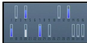
Se il dispositivo ha rilevato dei satelliti, nella vista con le informazioni sui satelliti viene visualizzata una barra per ciascuno di essi. Più lunga è la barra, più forte è il segnale satellitare. Quando il dispositivo ha ricevuto dal segnale satellitare dati sufficienti per calcolare la posizione, la barra cambia colore.
