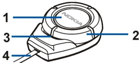
**1 - Κουμπί:** Χρησιμοποιείται για την απάντηση ή τον τερματισμό μιας κλήσης. Μπορεί επίσης να χρησιμοποιηθεί για φωνητική κλήση, επανάκληση και εναλλαγή μιας ενεργής κλήσης μεταξύ του car kit και του τηλεφώνου.
