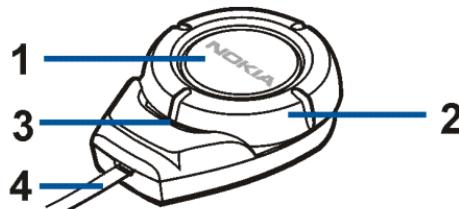
**1 - Кнопка:** Використовується, щоб відповісти на дзвінок або завершити його. Цю кнопку також можна використовувати для голосового набору, повторного набору та перемикання активного дзвінка між автомобільним комплектом та телефоном.
