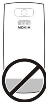
يبين الشكل منطقة هوائي شبكة GSM مميزًا باللون الرمادي.
