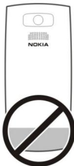
La zone de l'antenne GSM est grisée sur la figure.
