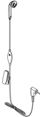
Sie können mit dem Nokia Card Phone auch Sprachanrufe durchführen. Hierzu benötigen Sie das Freisprechset HDC-6D. Mit der Fernsteuertaste im Mikrofonteil der Portable Freisprecheinrichtung können Sie Gespräche annehmen und beenden. Das Freisprechset wird an Buchse angeschlossen, die sich an der Seite des Nokia Card Phone befindet.
