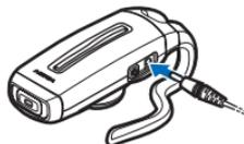
En pleine charge, la batterie offre une autonomie de 5 heures et 30 minutes en communication et de 150 heures en veille. Cependant, le temps de conversation et le temps de veille peuvent varier selon les téléphones mobiles, les produits utilisant une connexion Bluetooth, les paramètres et conditions d'utilisation et les environnements.
