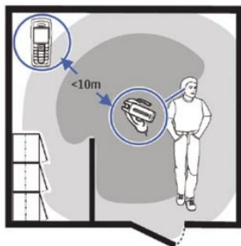
Le kit oreillette est conforme à la spécification Bluetooth 2.0 + EDR prenant en charge les modes suivants : Headset Profile 1.1 et Hands-Free Profile 1.5. N'hésitez pas à consulter les constructeurs des autres appareils pour déterminer leur compatibilité avec cet appareil.
