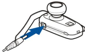
nuovamente e riprovare. La carica completa della batteria può richiedere fino a 2 ore.
