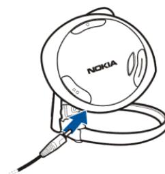
Продолжительность полной зарядки аккумулятора может составлять до 4 часов. Когда аккумулятор полностью заряжен, индикатор горит синим цветом.
