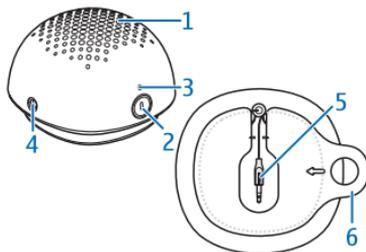
Der Lautsprecher enthält folgende Komponenten: Lautsprecher (1), Ein-/Aus-Schalter (2), Statusanzeige (3), 3,5-mm-Klinkenstecker (4), Lautsprecherkabel mit 3,5-mm-Klinkenstecker (5), Batteriefachabdeckung und Wickeldorn für das Lautsprecherkabel (6).
