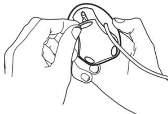
Zum Schließen des Cradles drücken Sie den Knopf auf der Seite des Cradles. Wenn Sie die Halterung nicht benutzen, können Sie das USB-Kabel um die Vertiefungen auf beiden Seiten der Halterung wickeln.
