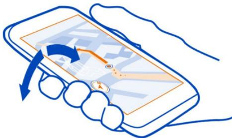
La brújula tiene una precisión limitada. Los campos electromagnéticos, los objetos metálicos u otras circunstancias externas también pueden afectar a la precisión de la brújula. La brújula siempre debería estar perfectamente calibrada.
