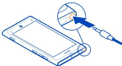
Non collegare prodotti che generano segnali in uscita, in quanto ciò potrebbe danneggiare il dispositivo. Non collegare il connettore audio ad alcuna fonte di alimentazione. Se si collega un dispositivo esterno o un auricolare diverso da quello approvato da Nokia per questo dispositivo al connettore audio, prestare particolare attenzione al livello del volume.
