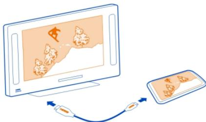
Non collegare prodotti che generano segnali in uscita, in quanto ciò potrebbe danneggiare il dispositivo. Non collegare il connettore AV Nokia ad alcuna fonte di alimentazione. Se si collega un dispositivo esterno o un auricolare, diverso da quello approvato da Nokia per questo dispositivo, al connettore AV Nokia, prestare particolare attenzione al livello del volume.
