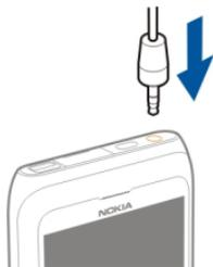
Non collegare prodotti che generano segnali in uscita, in quanto ciò potrebbe danneggiare il dispositivo. Non collegare il connettore AV Nokia ad alcuna fonte di alimentazione. Se si collega un dispositivo esterno o un auricolare, diverso da quello approvato da Nokia per questo dispositivo, al connettore AV Nokia, prestare particolare attenzione al livello del volume.
