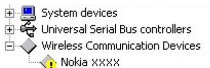
**Figura 2. Instalação não sucedida (xxxx corresponde ao número com quatro algarismos do modelo do telefone)**
