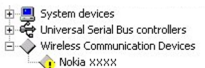
Obrázok č. 2. Neúspešná inštalácia (písmená xxxx označujú štvorciferné číslo modelu telefónu)
